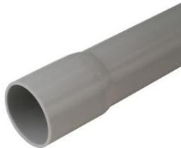
Das Installationsrohr schützt die Elektroleitung vor Schäden und erleichtert besonders bei unebenen Wänden die Verlegung Aufputz deutlich Material: PVC, flammwidrig, selbst verlöschend, korrosionsfest Anwendung: Für leichte mechanische Beanspruchung (320N) Mit einseitig angeformter Muffe zur Verbindung von weiteren Isorohren
