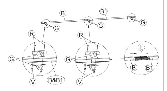
Verbinden Sie die beiden Streben (B + B1) mittels Verbindungsstück (L). Danach verbinden Sie die Pfostenhalterungen mit den Balken und fixieren diese mit den Schrauben und Muttern (R + V). Hinweis: Um sich das Einsetzen der Pfosten zu erleichtern, ziehen Sie die Schrauben noch nicht ganz fest.
