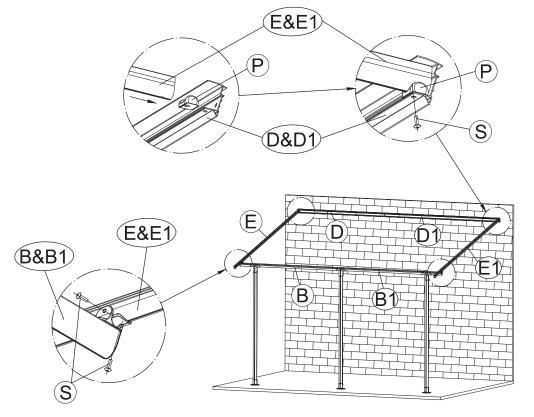
Verbinden Sie die Dachstreben (E + E1) mit den Verbindungsstücken (P), mit den Wandschienen (D + D1) und Streben (B + B1). Fixieren Sie die Verbindung mit den Schrauben (S).
