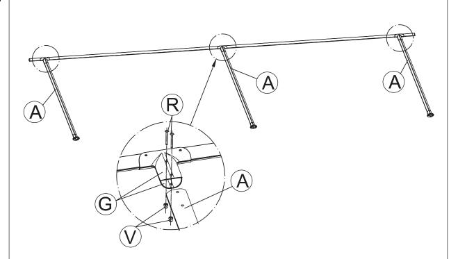
Führen Sie die Pfosten (A) in die Pfostenhalterungen (G) ein und fixieren Sie die Verbindung mit den Schrauben und Muttern (R + V). Hinweis: Ziehen Sie nun alle Schrauben der Pfostenhalterung fest.
