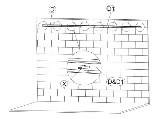
Fixieren Sie die Wandschiene (D + D1) mit den Wand- und Bodenankern (X) an der Wand.
