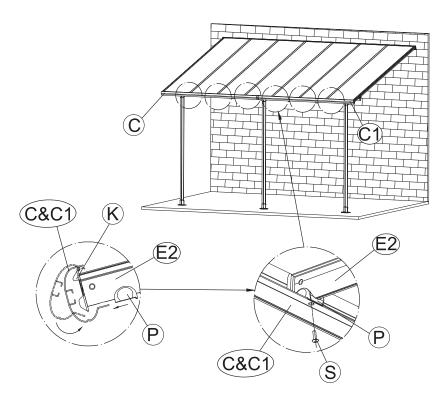
Verbinden Sie den Vorderbalken (C + C1) mit den Dachstreben (E2). Befestigen Sie die Verbindungsstücke (P) an der Unterseite der Dachstreben (E2). Achten Sie darauf, dass die Verbindungsstücke (P) über der Unterkante der Vorderbalken (C + C1) sitzen und fixieren Sie diese mit den Schrauben (S).
