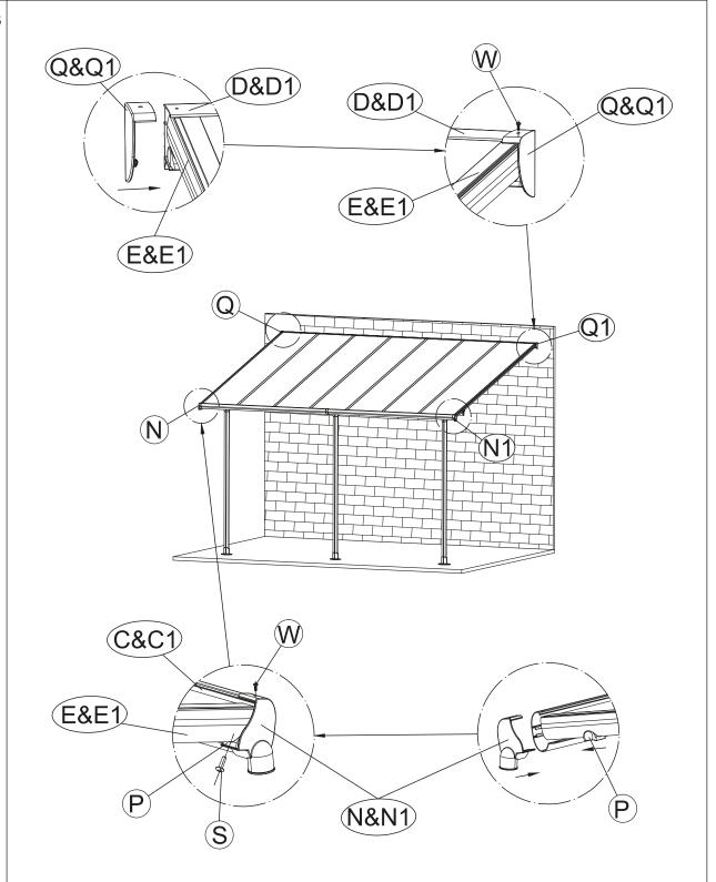
Setzen Sie die Abdeckkappen (Q + Q1) auf die Wandschienen (D + D1) auf und fixieren Sie diese mit den Schrauben (W).
