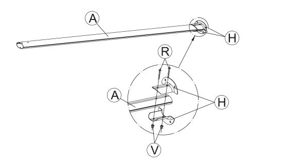
Verbinden Sie die Standfüße (H) mit den Pfosten (A) und fixieren Sie diese mit den Schrauben und Muttern (R + V).
