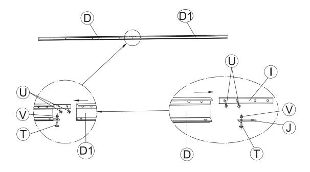
Verbinden Sie die Wandschienen (D + D1) mit den Verbindungsschienen (I + J). Die längere Verbindungsschiene (I) befestigen Sie mit den Schrauben (U) und die kürzere Verbindungsschiene (J) mit den Schrauben und Muttern (T + V).
