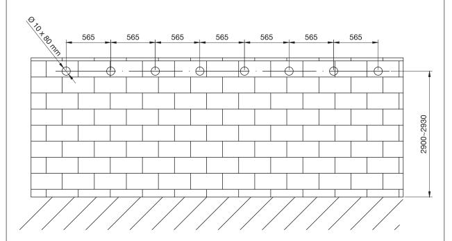
Markieren Sie die Bohrlöcher für die Montage der Wandschiene. Die Bohrlöcher müssen sich in einer Höhe von 290 – 293 cm befinden und einen Abstand von 56,5 cm zueinander haben. Bevor Sie mit dem Bohren beginnen, ist es ratsam, die waagrechte Ausrichtung der Bohrmarkierungen zu prüfen. Nehmen Sie hierfür eine Wasserwaage zur Hilfe. Nachdem Sie die Bohrlöcher markiert haben, bohren Sie die 8 Löcher mit einem Durchmesser von 10 mm und einer Tiefe von 80 mm.
