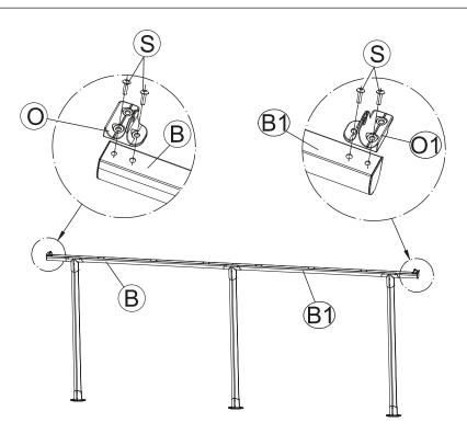
Verbinden Sie die Dachstrebenhalterungen (O + O1) mit den Streben (B + B1) und fixieren Sie diese mit den Schrauben (S).
