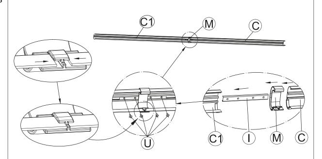
Verbinden Sie die Vorderbalken (C + C1) mit dem Verbindungsstück (M) und der Verbindungsschiene (I). Fixieren Sie die Verbindung mit den Schrauben (U).
