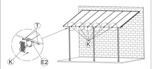
Setzen Sie die Abdeckungen (K) auf die Dachstreben (E2) und fixieren Sie diese mit den Schrauben (T).
