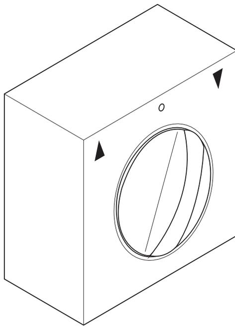
Bei der Schalterstellung ▼ (AB) muss die Markise ausfahren, andernfalls muss das Kabel für die ▲ (Auf) und ▼ (AB)-Richtung im Steuerelement getauscht werden.
