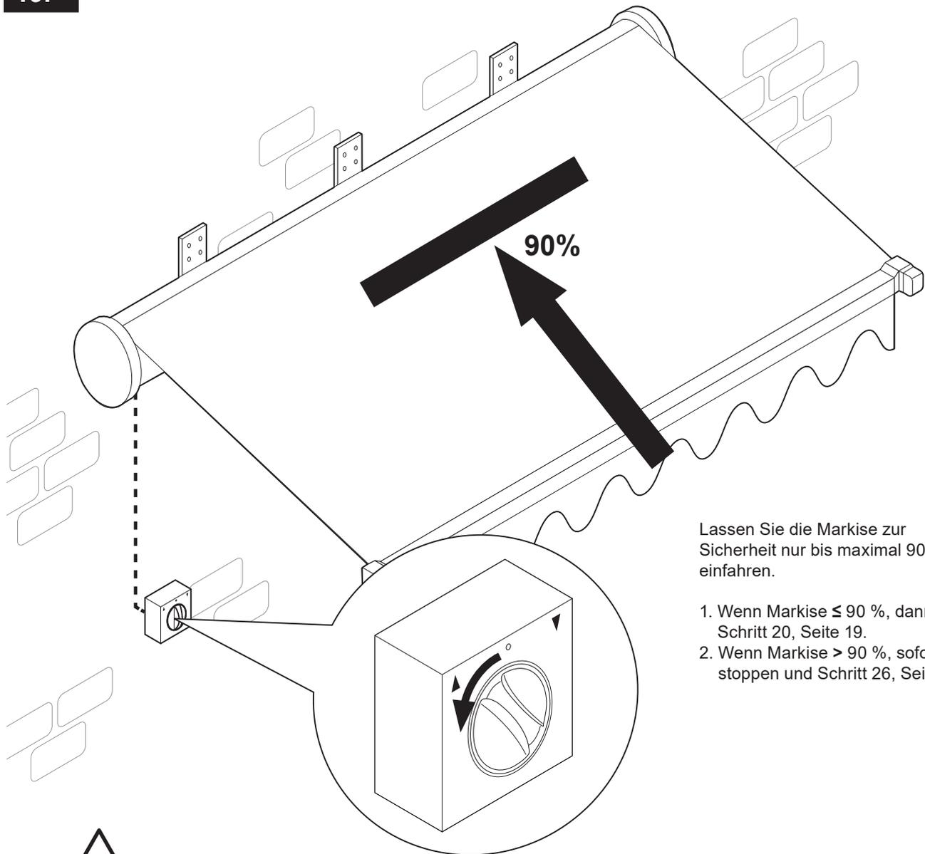
Lassen Sie die Markise zur Sicherheit nur bis maximal 90 % einfahren.
