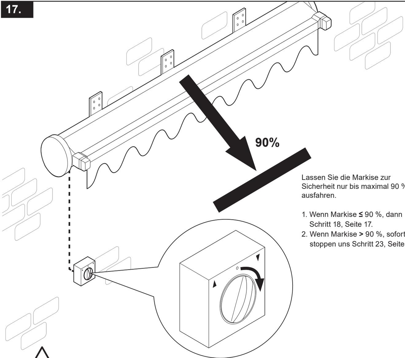
Lassen Sie die Markise zur Sicherheit nur bis maximal 90 % ausfahren.
