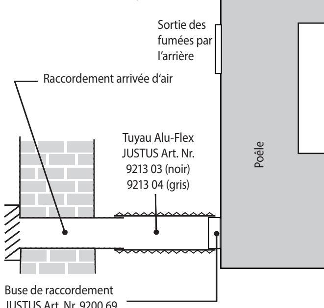
l'appareil, doit avoir une section libre d'ouverture de  $0,5 \text{ dm}^2$  ( $50 \text{ cm}^2$ ).
