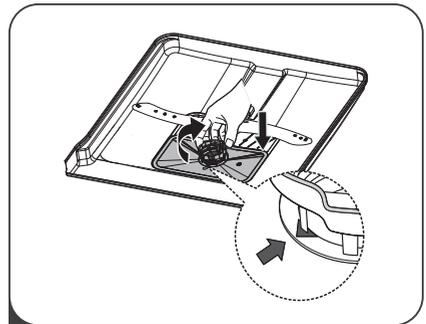
**4** Setzen Sie die Filter in umgekehrter Reihenfolge wieder zusammen, setzen Sie den Filtereinsatz wieder ein und drehen Sie ihn im Uhrzeigersinn bis zum Schließfeil.
