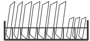
Der empfohlene maximale Durchmesser für Platten vor dem Spülmittelbehälter ist 19 cm.
