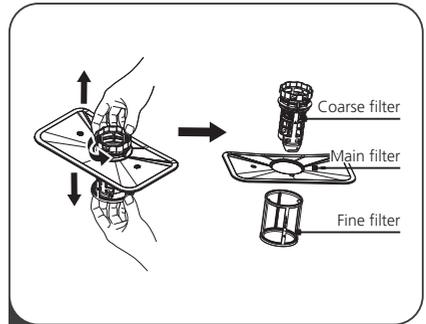
**2** Der Feinfilter kann vom Boden der Filtereinheit abgezogen werden. Der Grobfilter lässt sich vom Hauptfilter lösen, indem man die Laschen oben leicht zusammendrückt und wegzieht.
