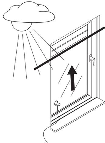
Wird der Grenzwert unterschritten, fährt der Rollladen bis zur oberen Endlage.
