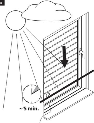
Wird der Grenzwert weitere 5 Minuten überschritten, fährt der Rollladen bis zur Position des Sensors herunter.
