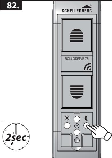
Durch Drücken der Taste Dämmerung wird die Dämmerungsfunktion ein- oder ausgeschaltet:
