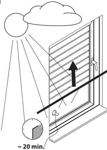
Nach ca. 20 Minuten fährt der Rollladen ein Stück über den Sensor, der erneut die Helligkeit misst.
