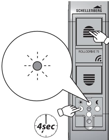
Durch das Drücken der beiden Tasten wird das Produkt in den Programmiermodus versetzt. Ab diesem Zeitpunkt muss innerhalb von 10 Sekunden der Funk-Handsender gekoppelt werden (Schritte 88 bis 89). Sind 10 Sekunden vergangen, ohne den Funk-Handsender zu koppeln, muss das Produkt durch das Wiederholen des Schrittes 87 erneut in den Programmiermodus versetzt werden.
