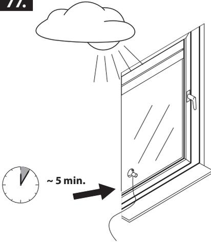
Bei Überschreitung des Grenzwertes erfolgt eine fünfminütige Messung.
