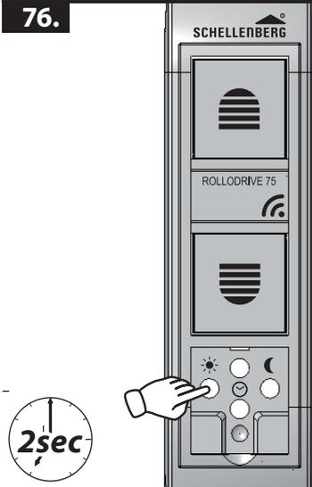
Durch Drücken der Taste Sonne wird die Sonnenfunktion ein- oder ausgeschaltet:
