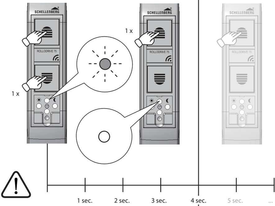
Taste Auffahrt und Abfahrt gleichzeitig drücken. Danach innerhalb von 4 Sekunden die Taste Auffahrt zur Bestätigung drücken. Endlage oben gesetzt.
