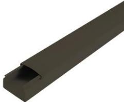
Zur Verlegung elektrischer Leitungen Dient dem Schutz und der mechanischen Entlastung von Leitungen Material: PVC, schwer entflammbar, selbst verlöschend Unterteil mit regelmäßiger Bodenlochung Mit Deckel Maße: 30x30mm Temperaturbereich: 5°C bis +60°C
