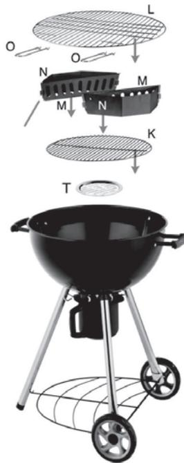
9. Legen Sie das Aschegitter (T) lose über das Loch des Aschebehälters. Nutzen Sie entweder die zwei Kohleabstandshalter (M+N) für einen indirekten Grillvorgang oder alternativ das Kohlerost (K) für einen normalen Grillvorgang. (Bild 5)
