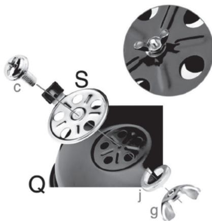
2. Befestigen Sie die Belüftungsscheibe (S) in der dafür vorgesehenen Mulde am Deckel (Q). Schieben Sie die Schraube M5 x10 (c) von außen durch die Bohrung und sichern Sie diese von innen mit dem Sprengring (j) und der Flügelmutter (g). (Bild 2)
