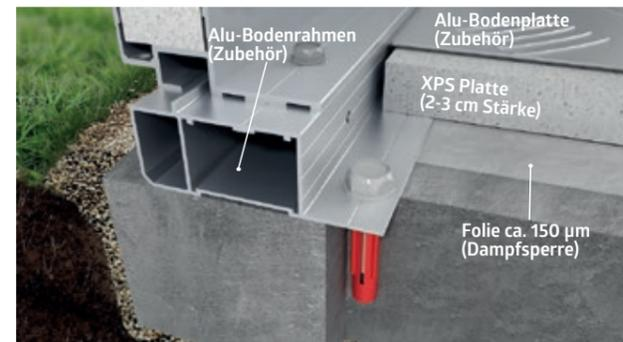
**b) Stufenfundament – kein Bodenrahmen notwendig**
