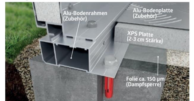
**b) Punktfundament: Sicherlich aufwendiger, aber auch möglich. Befestigung wie beim Streifenfundament.**
