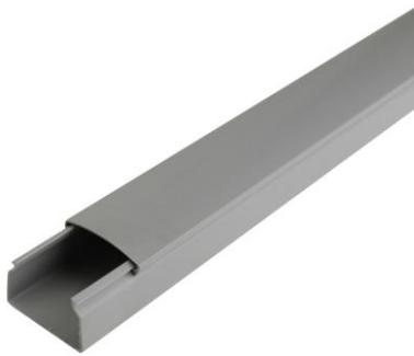
Zur Verlegung elektrischer Leitungen Dient dem Schutz und der mechanischen Entlastung von Leitungen Material: PVC, schwer entflammbar, selbst verlöschend Unterteil mit regelmäßiger Bodenlochung Mit Deckel Maße: 25x40mm Temperaturbereich: 5°C bis +60°C
