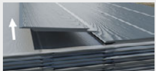
Hardie® VL Plank Fassadenplatten werden ineinander gesteckt geliefert. Paneele sind bei der Entnahme von der Palette seitlich herauszuziehen und erst dann anzuheben.
