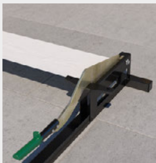
Beim Zuschneiden mit dem Hardie™ Guillotine Schneidwerkzeug muss die beschichtete Seite nach oben zeigen.
