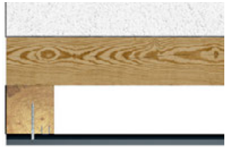
Bündige Montage der Fassadenplatten an der Fensterlaibung
