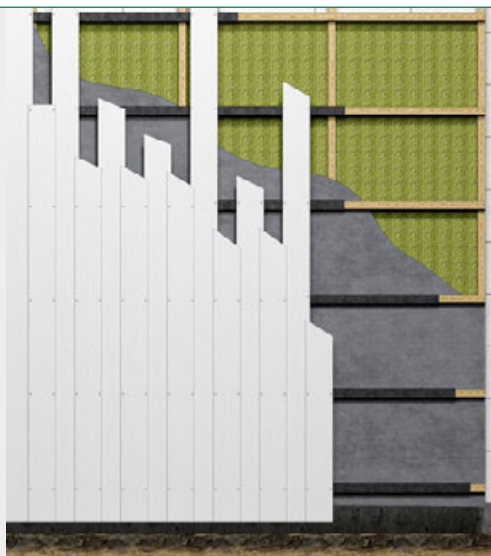
Anordnung der Boden-Deckel-Schalung.
