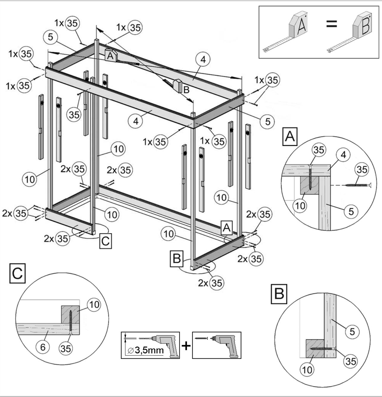
Die oberen Wandbohlen werden nur vorübergehend als Montagehilfe befestigt ( Abb.4), später wieder abgenommen und an anderer Stelle montiert. (Abb.7)
