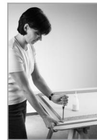
Nach dem gleichen Prinzip verfahren Sie beim Verleimen und Zusammenbauen der Zierbekleidung (**Verleimzeit beachten**). Dann stellen Sie die zusammengebaute Zarge in die Maueröffnung (siehe Seite 3).
