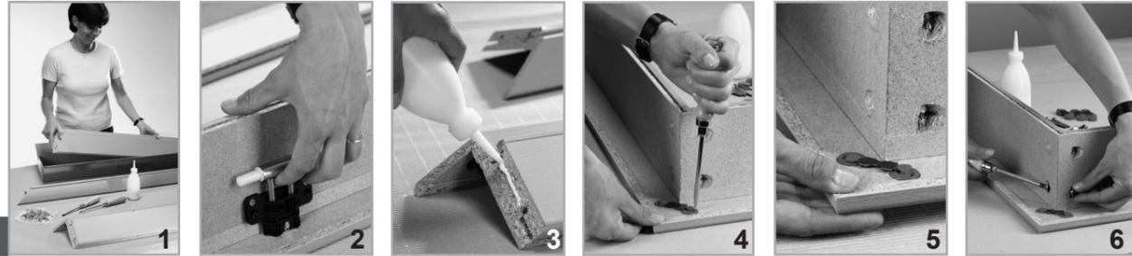
Legen Sie die ausgepackten Zargenteile auf eine Arbeitsplatte. Eine Kartonunterlage verhindert das Verkratzen der Oberfläche.
