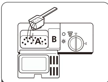
**2** Geben Sie Spülmittel in die größere Mulde (A) für den Hauptwaschgang . Geben Sie bei stärker verschmutzten Waschladungen auch etwas Spülmittel in die kleinere Mulde (B) für den Vorspülgang .
