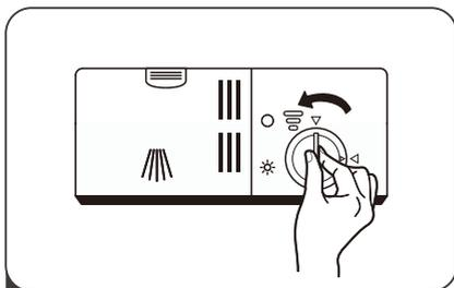
**1** Entfernen Sie die Kappe des Klarspülmittelbehälters, indem Sie sie gegen den Uhrzeigersinn drehen.
