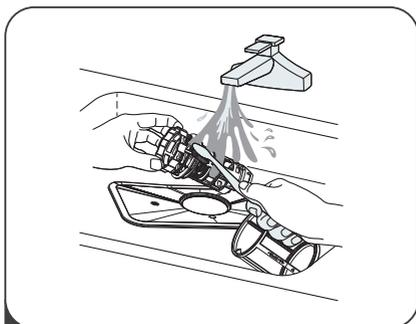
**3** Größere Speisereste können durch Spülen des Filters unter fließendem Wasser gereinigt werden. Für eine gründlichere Reinigung verwenden Sie eine weiche Reinigungsbürste.
