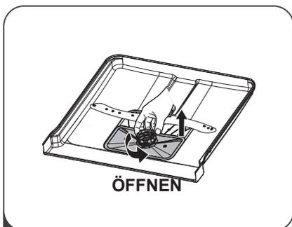
**1** Halten Sie den Grobfilter fest und drehen Sie ihn gegen den Uhrzeigersinn, um den Filter zu entriegeln. Heben Sie den Filter nach oben aus der Spülmaschine.
