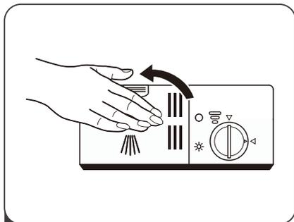
**3** Schließen Sie die Abdeckung und drücken Sie darauf, bis sie einrastet.
