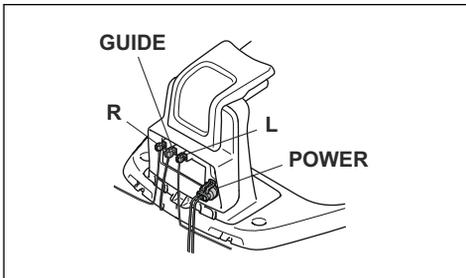
3. Verbinden Sie die Anschlüsse von Leitkabel und Begrenzungskabel mit der Ladestation.
