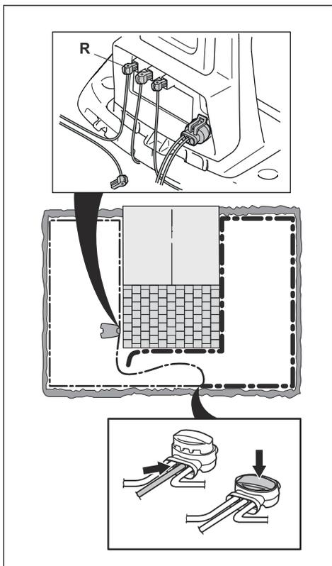
Blinkt die Anzeigelampe jetzt gelb, befindet sich der Bruch an einer Stelle zwischen dem ausgesteckten Ende und der Stelle, an der das neue Kabel angeschlossen wurde (dicke schwarze Linie unten). Verschieben Sie in diesem Fall das neue Kabel näher in Richtung ausgestecktes Ende (ungefähr in der Mitte des Bereichs, in dem der Bruch vermutet wird), und prüfen Sie erneut, ob die Anzeigelampe grün leuchtet.
