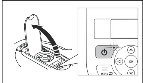
3. Stellen Sie sicher, dass das Gerät deaktiviert ist. Die Anzeige an der **ON/OFF**-Taste geht aus, wenn das Gerät deaktiviert ist. Siehe *Tastatur auf Seite 12*.
