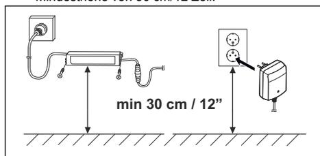
5. Schließen Sie das Netzteil an eine Steckdose mit 100–240 V an.
