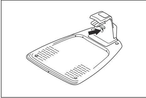
2. Prüfen Sie, ob Begrenzungskabelanschlüsse an der Ladestation korrekt vorgenommen wurden und nicht beschädigt sind. Prüfen Sie, ob die Anzeigelampe an der Ladestation noch immer blau blinkt.
