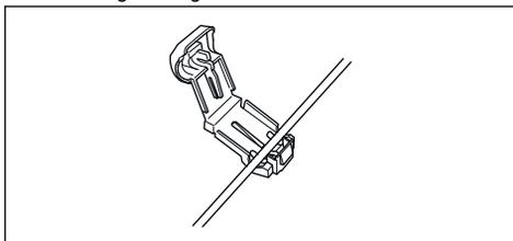
3. Schließen Sie die Anschlussklemme mit einer Zange.
